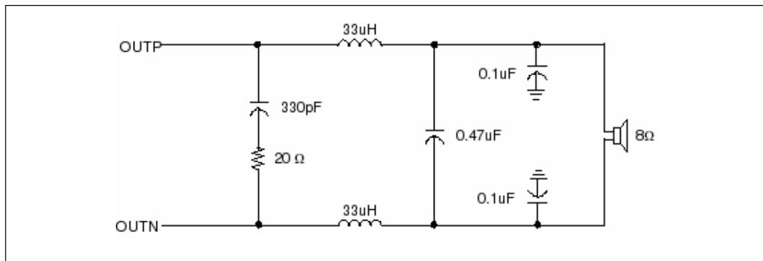
图 21. 适用于4Ω扬声器的典型LC滤波器
