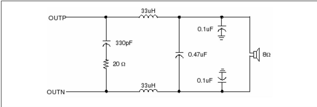
**图 21. 适用于4Ω扬声器的典型LC滤波器**
